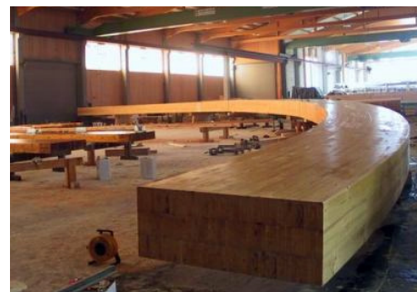
Ansicht auf den fertig verleimten, gefrästen und lackierten Träger im Werk
