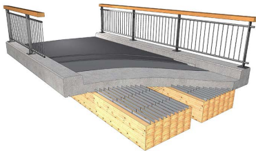
Verbund über eingeklebte Blechen
