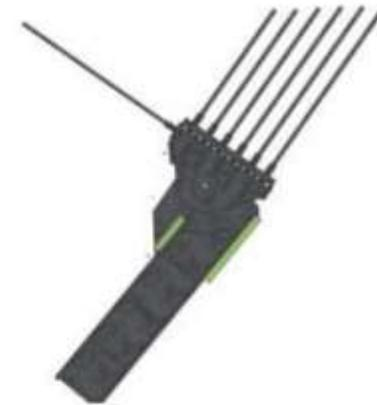
Scellement de la ferrure dans les réservations en tête de pile, incluant un jeu de pose.
