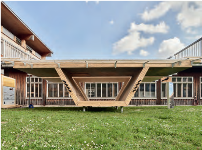
Abb. 17: Arbeitsmodell aus zwei Modulen zu Brückentragquerschnitten als Hohlkasten in Holz
